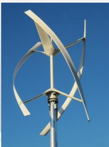
turbina z wirnikami o osi pionowej
